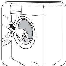
Відкрийте дверцята, зніміть полістирольний блок, приспособлений до ізоляції дверцят.
